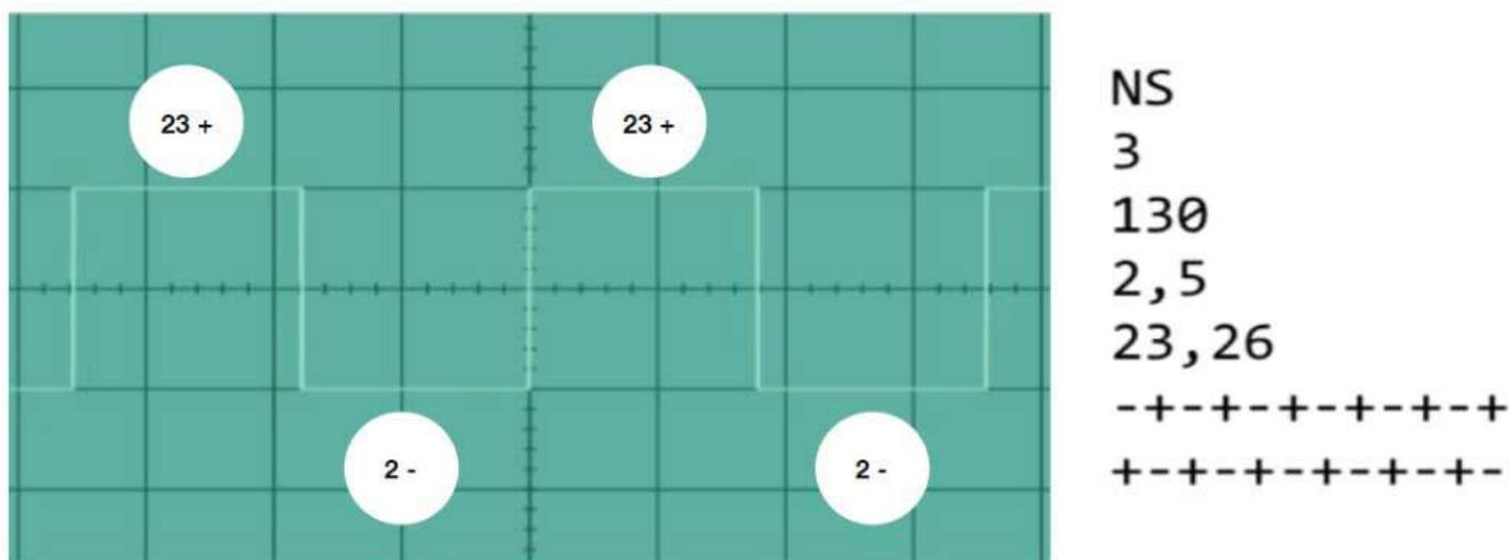
Illustrazione 4: grafico della microcorrente NESAs. Nell'immagine a destra è specificato il numero di sequenza (NS) di un determinato programma. NS si verifica per 130 secondi e si attivano gli elettrodi 2 e 5 (dei braccialetti) e 23 e 26 (delle cavigliere). In questo caso, è la corrente è bipolare..
