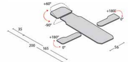
Letto a quattro sezioni ad altezza fissa, per rieducazione posturale e massaggi. Il letto è dotato di pediera regolabile mediante molla a gas e appoggia braccia laterali ruotabili e scorrevoli lungo tutto il piano. Il letto è inoltre predisposto per l'applicazione dell'asta di sostegno per le caviglie regolabile in altezza e completo di corda e cavigliera. Grazie alla sua struttura questo lettino permette il passaggio del sollevatore e una portata di 180 kg.
