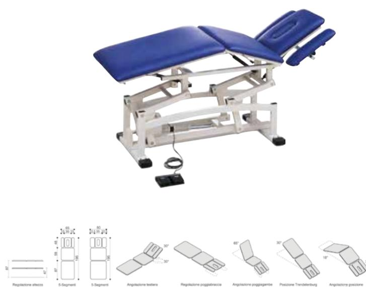
Letto a cinque segmenti regolabile elettricamente in altezza da cm. 45 a cm. 90 mediante comando a pedale. Testa regolabile da +60° a -20° mediante pistone a gas con appoggia braccia regolabili e foro per la respirazione completo di tappo. Il busto e la pedaliera sono regolabili in più posizioni mediante pistone a gas. Può assumere la posizione Trendelenburg. Il piano è imbottito e rivestito in similpelle lavabile, antibatterico/antiacaro ed ignifuga classe 1/IM. Portata massima 150 kg.
